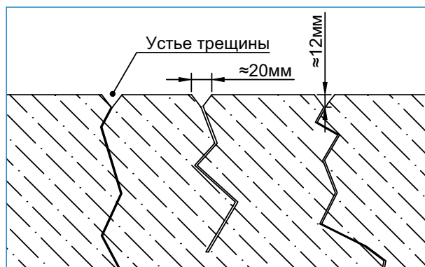
Узел Б. I Этап. Подготовка трещин.
