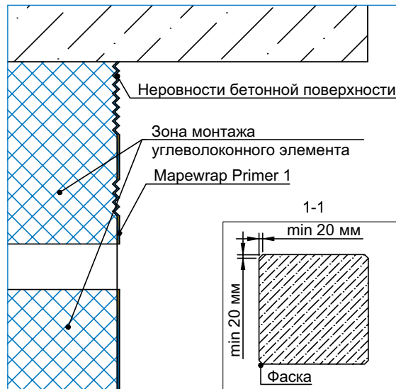
Узел Б. Подготовка и грунтование поверхности.
