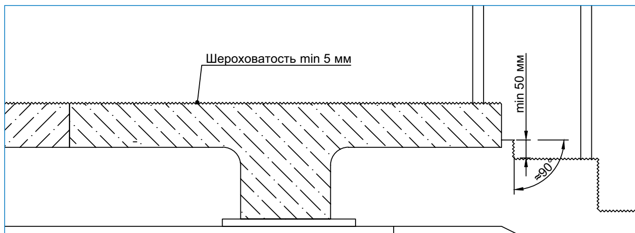
Узел А. I этап. Подготовка поверхности.
