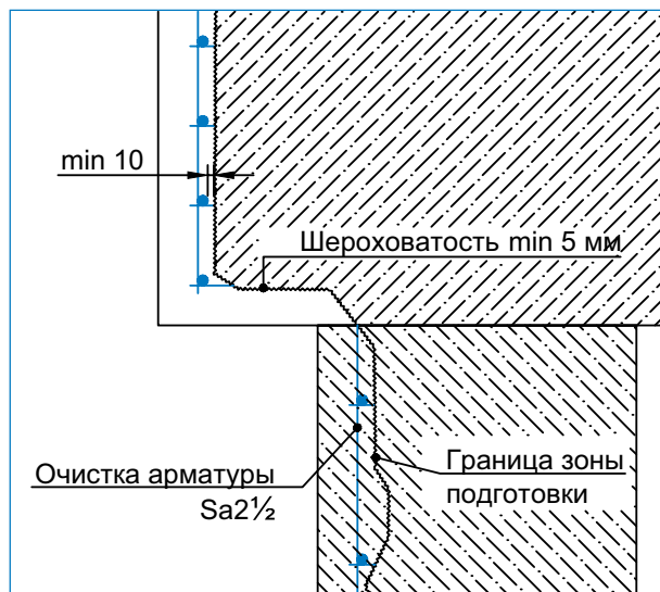
Узел А (I этап. Подготовка дефекта)
