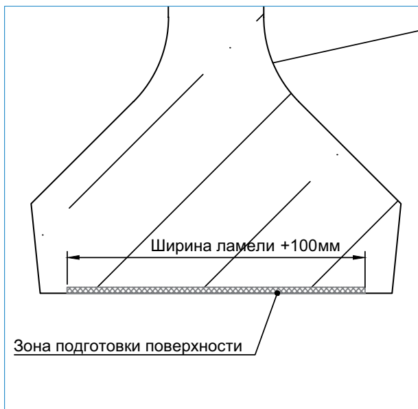
Узел А. I Этап. Подготовка поверхности.
