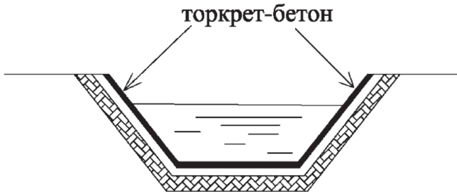
Рис. 6.3 – Торкретирование откосов и дна каналов
