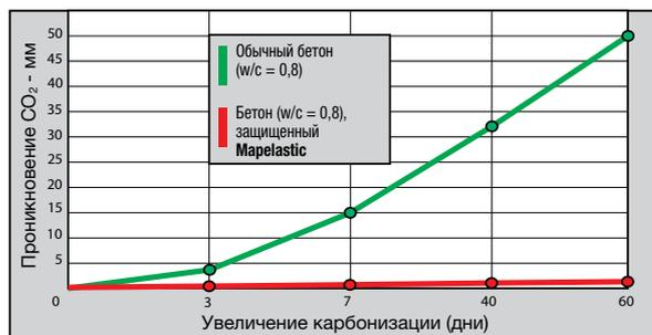
Рис. 2: Защита Mapelastic пористого бетона от ускоренной карбонизации (30% CO<sub>2</sub>)
